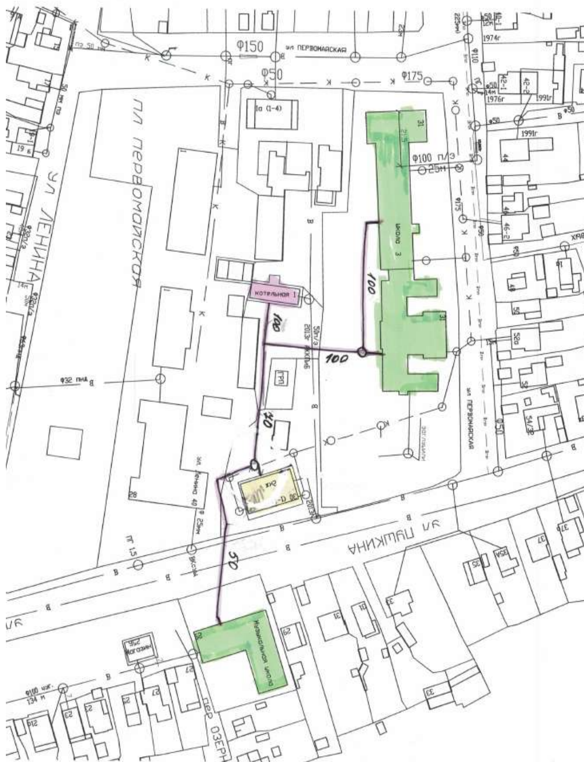
Рисунок 1.3.2.1 - Схема тепловых сетей котельной №1 г. Кинель
